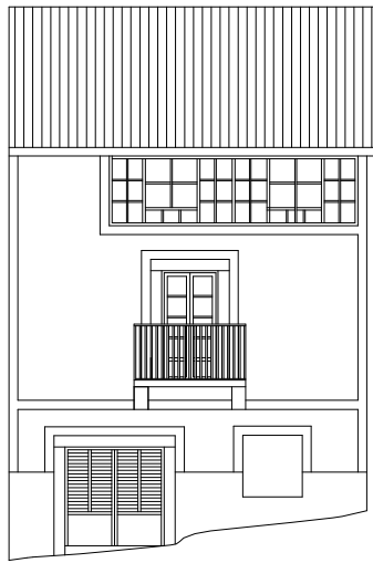
EJEMPLO 2: Modelo con galería parcial acristalada en la planta superior, con enfoscado oscuro poco habitual en la fachada principal, en contraste con el encalado de la fachada secundaria, por lo que probablemente sea bastante reciente.
